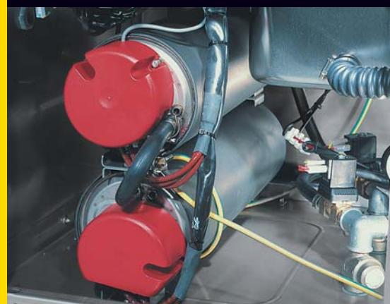
► Sistema di asciugatura per mezzo di un potente getto di aria ventilata, preriscaldata.
